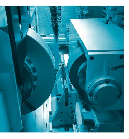
1 Die spitzenlose Schleifmaschine M100 ist ideal für das hochpräzise Durchgangs- oder Einstechschleifen geeignet
